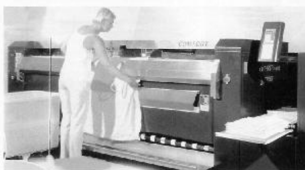
De speciaal voor Servall ontwikkelde mangel Miele Comfort, specifiek aangepast voor bedseparaties.
